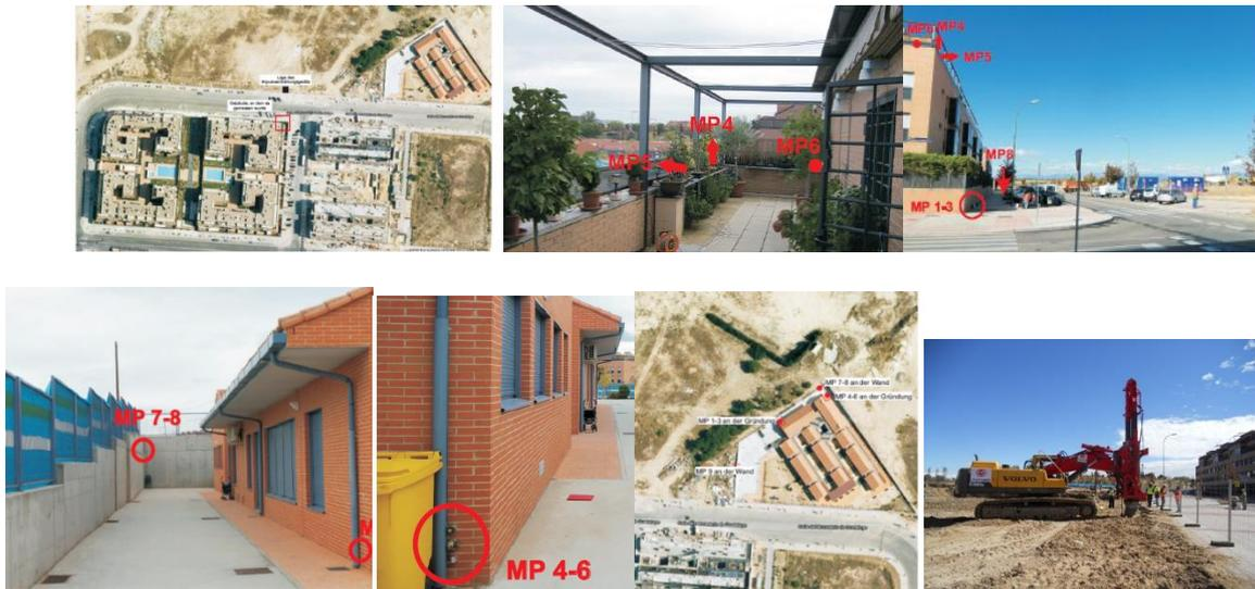
Figura 13. Auscultación de vibración edificios próximos
